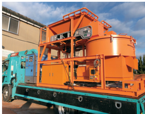
全国で廃瓦リサイクルの推進を可能にした車載式生コンクリートプラント
