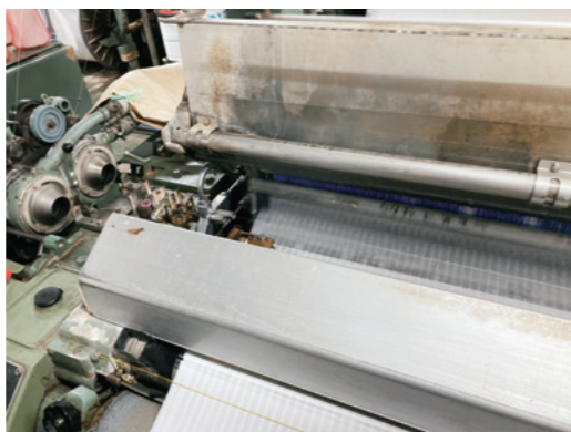
地下水を利用したウォータージェット機
