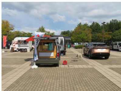
日産リーフ3台・アリア1台からキッチンカー6台への給電
