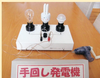
手で発電し、電球を光らせる簡易発電機
