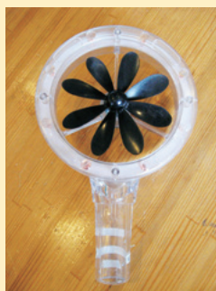
振ることで発電できる簡易発電機
