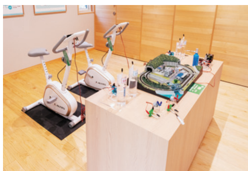
ペダルを漕ぐと発電できる足漕ぎ発電機。発電した電気で水素を作り、おもちゃの電車を動かします
