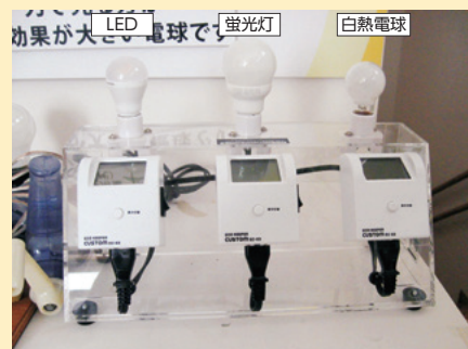
手回し発電により種類の異なる電球の消費電力の大きさを比較する装置
